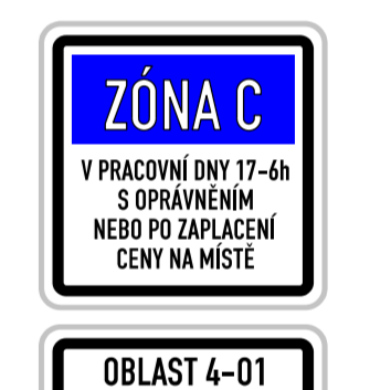
Vzorový vzhled vyplnění úsekových dodatkových tabulek E 13 s označením příslušných režimů a doby platnosti.
